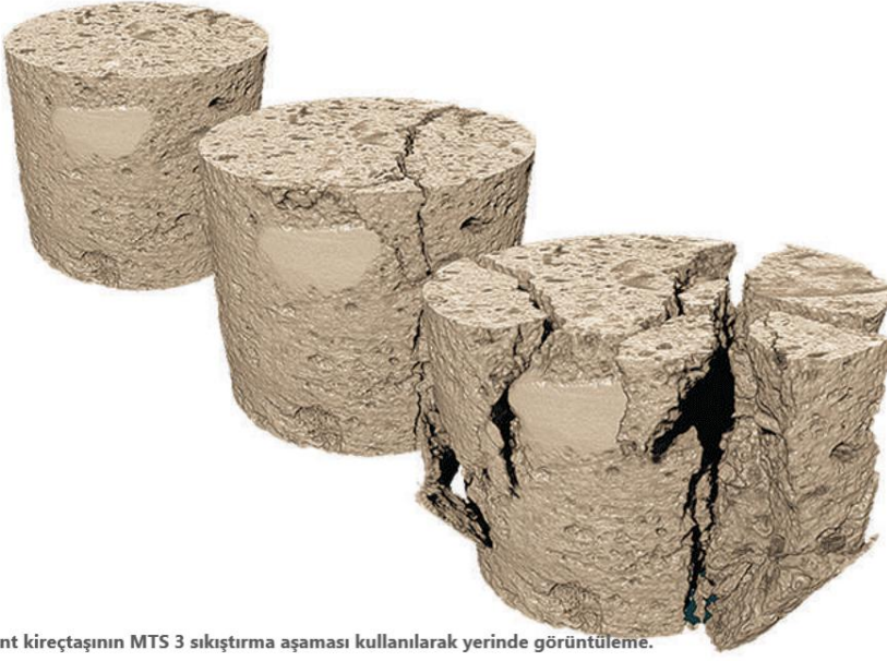
Noyant kireçtaşının MTS 3 sıkıştırma aşaması kullanılarak yerinde görüntüleme.
